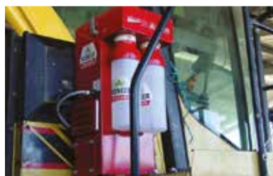
Appli-pro SLV szecskázóra felszerelve
